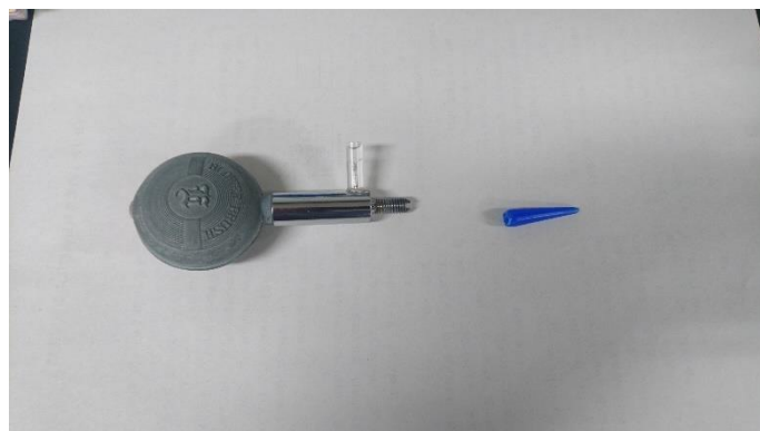
Figure 18 使用した噴霧器と作製した取付部品
