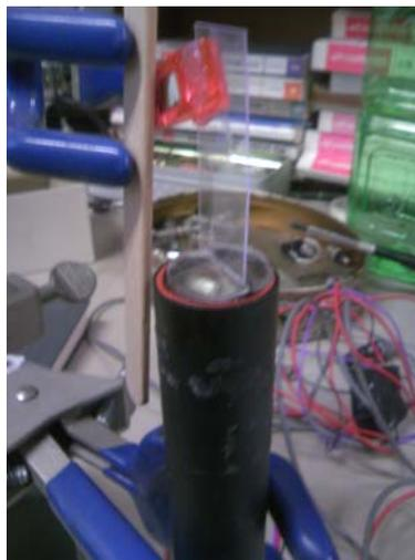
Fig. 3.4: 光電子増倍管とプラスチックシンチレータの接着
