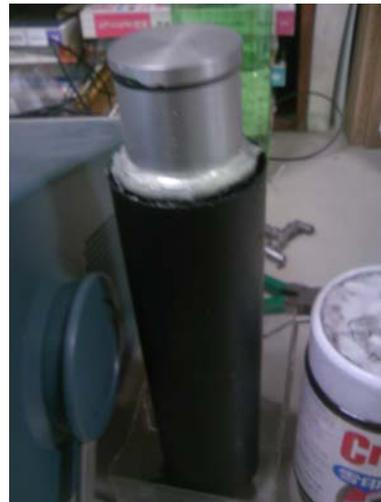
Fig. 3.3: 光電子増倍管と NaI 結晶の接着
