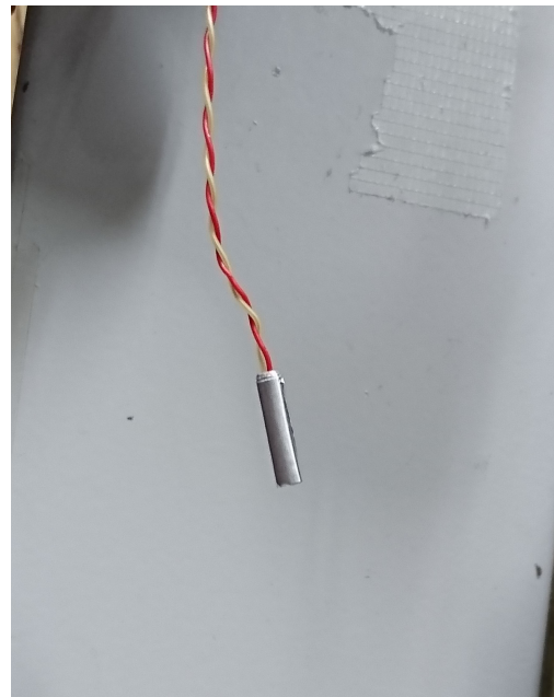
図 31: アルミテープを巻き付けて太くした熱電対
