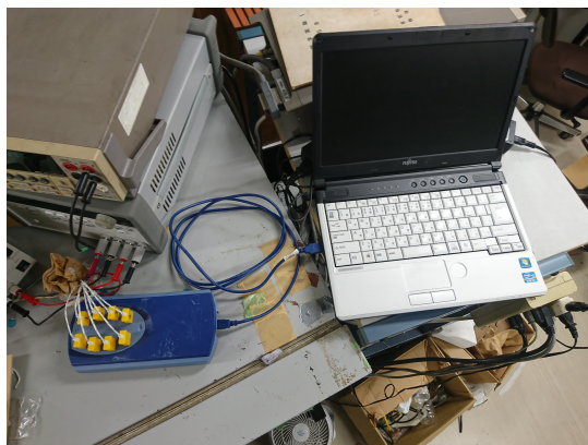
図 27: TC-08(青色) は USB ケーブルで PC に接続されている
