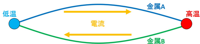
図 25: ゼーベック効果によって電圧が生じる
