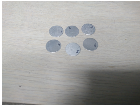
図 36: 厚さ 0.5 mm で打ち抜いたアルミニウムコイン
