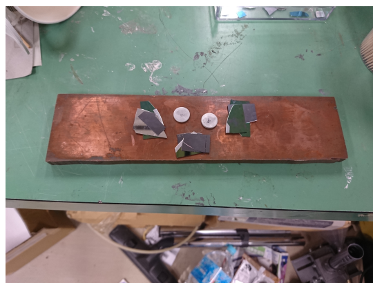
図 39: 平坦な銅板の上にスペーサー (3 点) とコインサンプル 2 枚を乗せているところ。この上にもう 1 枚の平坦な銅板を乗せる。
