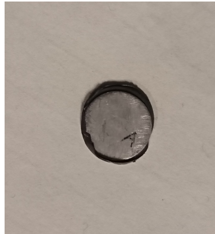
図 49: SE4445 CV で作製したコインサンプル 図 50: はみ出してしまった SE4445 CV(左のサンプルとは別サンプル)
