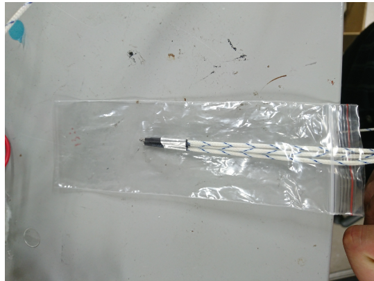
図 29: 熱電対を束ねてジップ付きの小袋に入れる (画像では 3 つしかないが、実際には 8 つの熱電対を入れて測定を行った)
