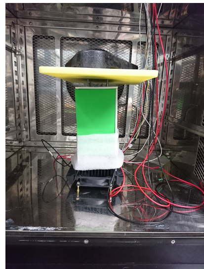
図 42: 防風ボックスと断熱シートをかぶせた状態
