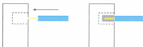
貼り付け方2.熱電対にアルミテープを巻いてから貼る
