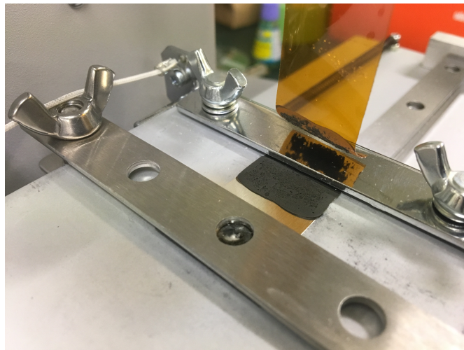
図 60: ID-243 : EG7655 の照射後サンプル。照射前はカプトン側に残っていたが、照射後は接着剤が両側に残っていた。
