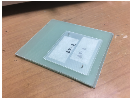
(d) 接着後、2 層目ごとダミーを位置出しピンから取り外す
