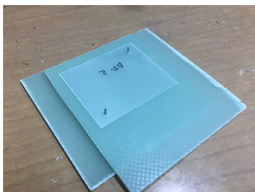
(a) ジグ 2 層目の上に Sensor-dummy が乗っている状態
