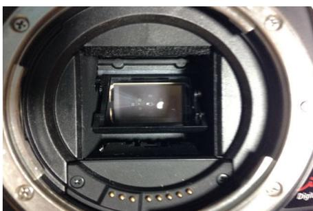
図 2: デジタルカメラの CMOS センサー
