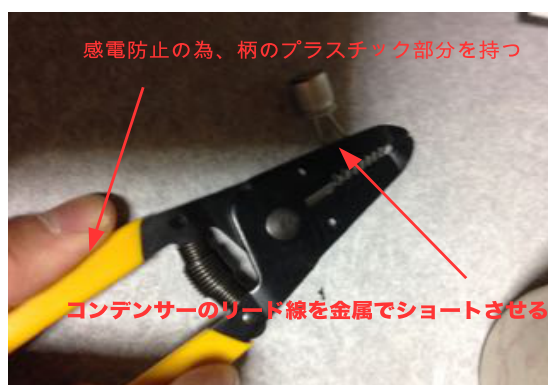
図 12: コンデンサーの放電のさせ方
