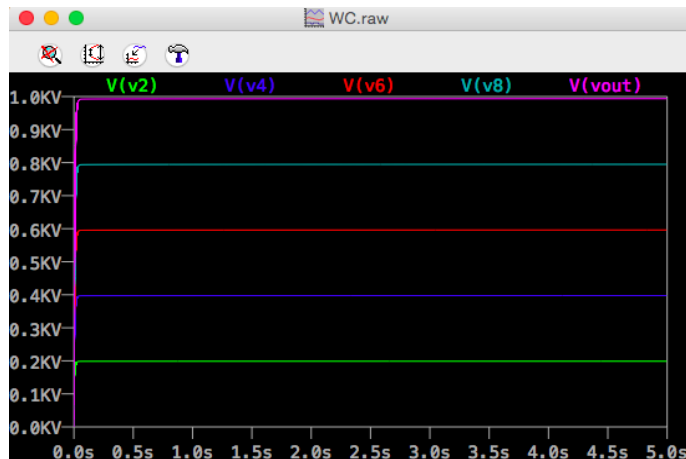
図 34: 回路図下のコンデンサーの電圧測定 (5000Hz)
